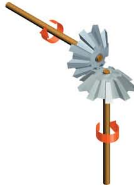
engrenage M conique bevel gear engranaje M cónico Kegelradgetriebe N ingranaggio M conico
